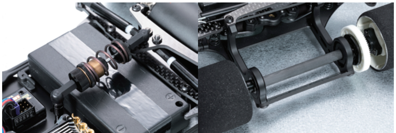
潤滑性と耐久性を両立したHQコートをしたビックボアタイプのセンターショックを標準装備。 軽量かつ低重心設計のモーターマウントは、左右共通タイプ。バックプレートは、2.0mmカーボン製で最適なしなりを生み出す。
